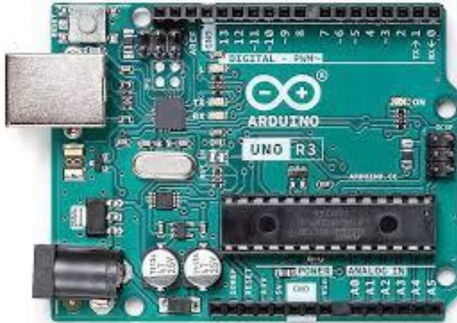
O Arduino Uno Rev3 é uma versão específica da placa de desenvolvimento Arduino Uno, e “Rev3” refere-se à revisão mais recente da placa . Aqui estão algumas características e informações sobre o Arduino Uno Rev3:
