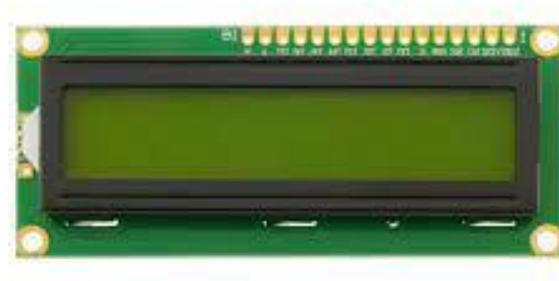
Um Display LCD 16x2 com Retroiluminação Amarela refere-se a um tipo de ecrã de cristal líquido que tem a capacidade de exibir 16 caracteres em 2 linhas e possui uma luz de fundo (retroiluminação) na
